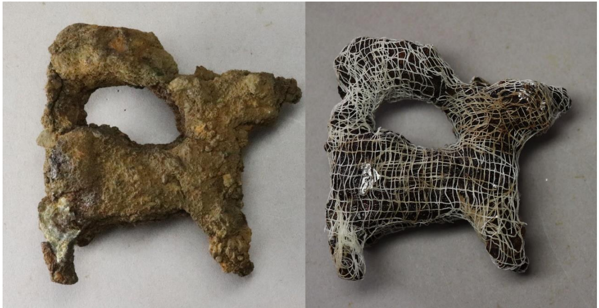
Рис.12 – Нанесение профзаклейки из марли на ослабленный железный предмет в процессе противоаварийной обработки. Из фондов Болгарского ГИАМЗ. Фотографии А.С. Лисиной.
