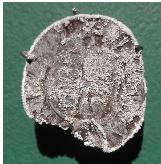
Рис.16 – Монета древнечешская князя Вацлава, свинец. Очаги активной коррозии. Фонд ГИАХМЗ «Казанский Кремль». Характерное проявление активной коррозии на предметах из свинца – сыпучие порошковые коррозионные образования ярко-белого цвета. Фотография Р.В. Котова.
