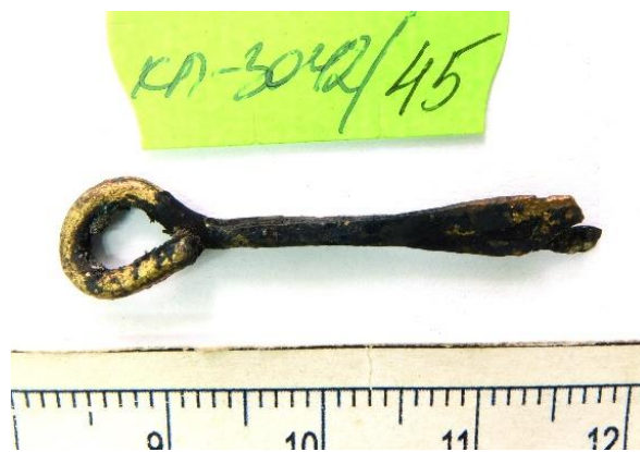
Рис. 15 – Пряжка, язычок, медный сплав. Раскоп «Татарская слободка», ГИАХМЗ «Остров-град Свияжск». Покрит слоем вязких продуктов коррозии меди чёрного цвета, тонкой плёнкой сульфидов меди золотистого цвета. Группа сохранности С-III. Фотография Р.В. Котова.
