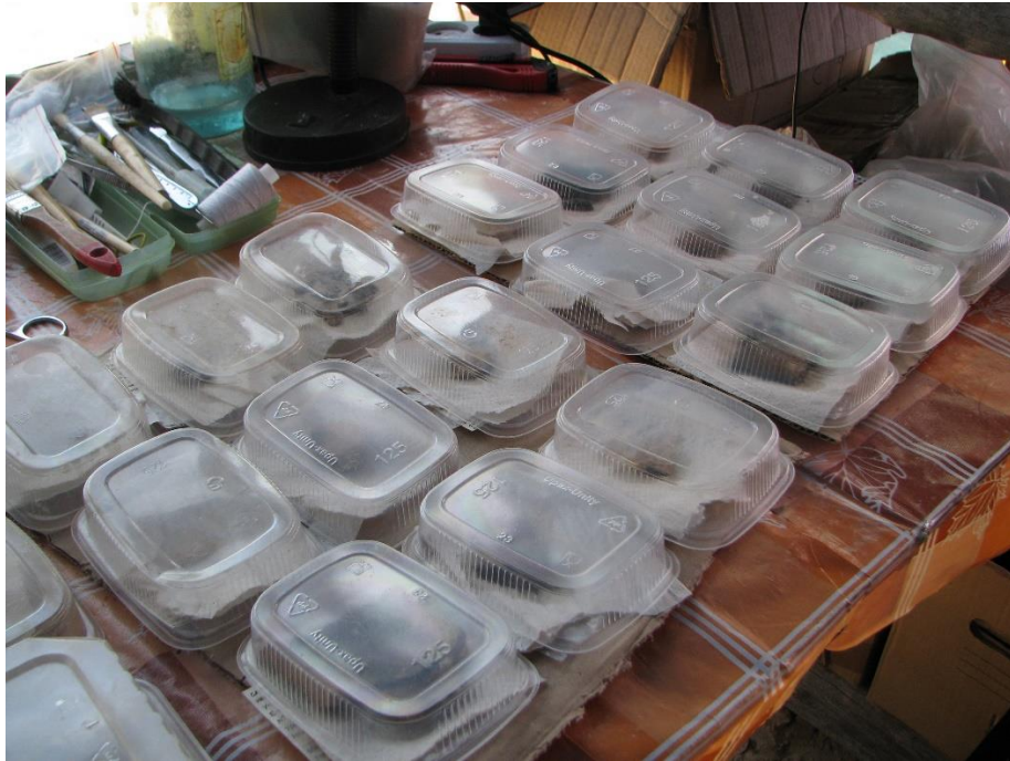
Рис.1 – Структурное укрепление ослабленной керамики в полевых условиях – пропитка «под колпаком». Экспедиция ООО «НПО Северная археология-1», городище Старые Покачи, Югра. Фотография С.Г. Буршневой.
