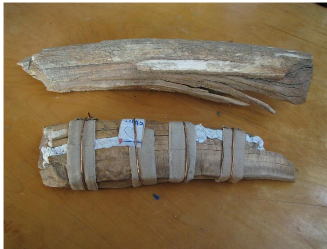
Рис.42 – Фрагменты изделий из бивня мамонта после сушки: верхний – сушка в естественных условиях, ведущая к расслоению и деформациям; нижний – замедленная сушка со стяжками и бумажными прокладками, в результате которой форма предмета не исказилась. Восточно-Якутская экспедиция ИИМК, Янская стоянка. Фотография С.Г. Буршневой.
