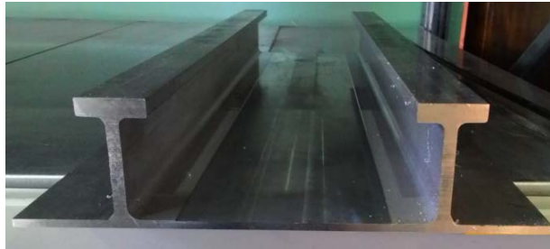
Фрагмент гибридной панели крыла, изготовленный из сплава В1469 с использованием СТП
