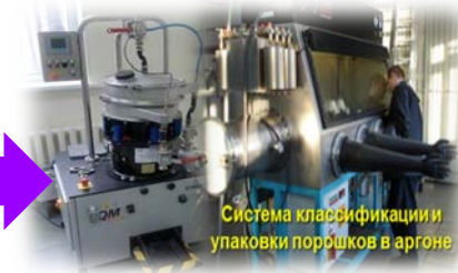
Система классификации и упаковки порошков в аргоне Рассев и газодинамическая сепарация порошков
